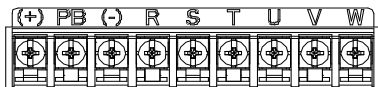
Рис. 3-6 Схема силовых клемм для ПЧ 3ф 220 В, ≥1.5 кВт и 3ф 380 В, 4-22 кВт)
